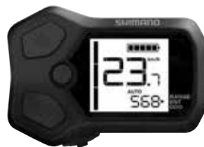
新 SC-E5000 系統顯示器配備助力模式按鈕
