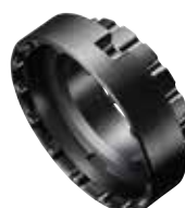
TL-FC39 DU-EP800/E8000/E7000/E6100/E5000 專用迫緊環工具
